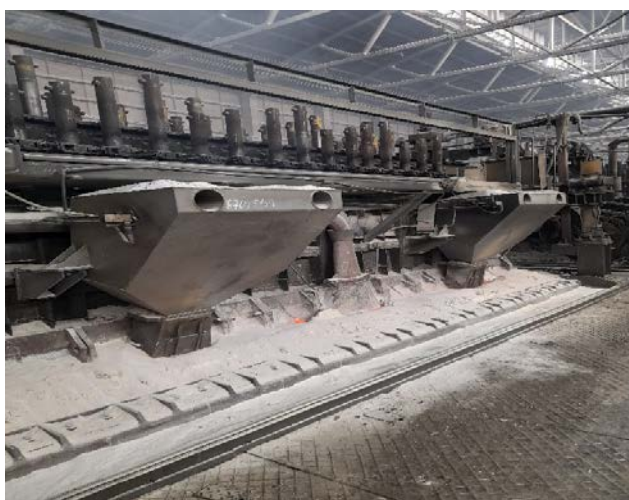
рис.3 Электролизер С-2(Э), С-3(Э), оснащённый системой АПС
