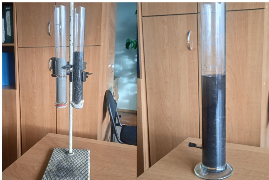
Рисунок 1 – Установка для определения влажёмкости и порозности
