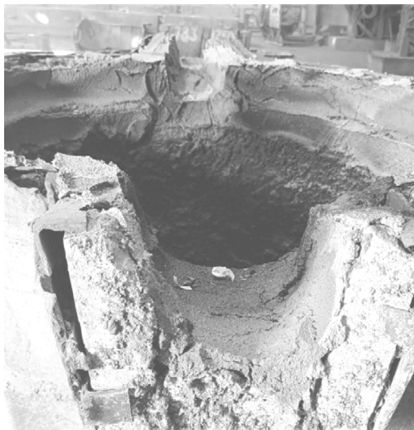
рис. 2 Недостаточно просушенный разливочный ковш
