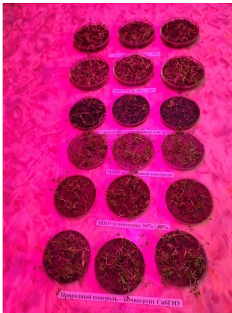
Рисунок 3 – Лабораторное биотестирование УО и ЗШО с использованием кресс-салата
