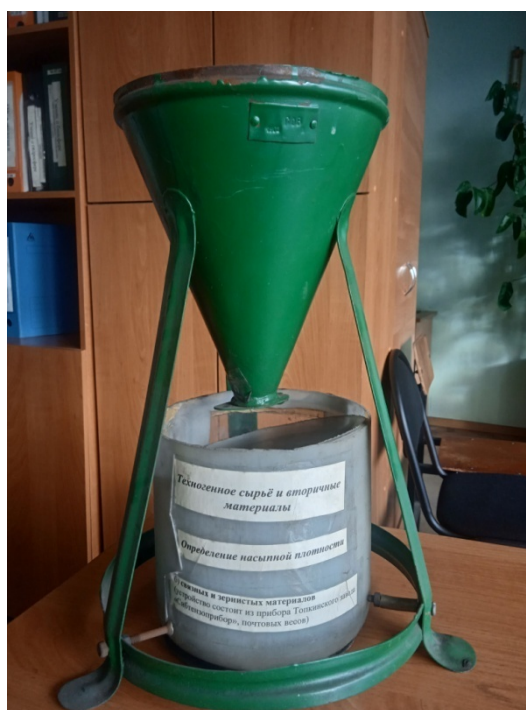
Рисунок 2 – Установка для насыпной плотности
